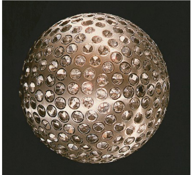
FIGURA 74 El satélite LAGEOS: esfera metálica con un diámetro de 60 cm, una masa de 407 kg, y cubierta con 426 retroreflectores (NASA).
