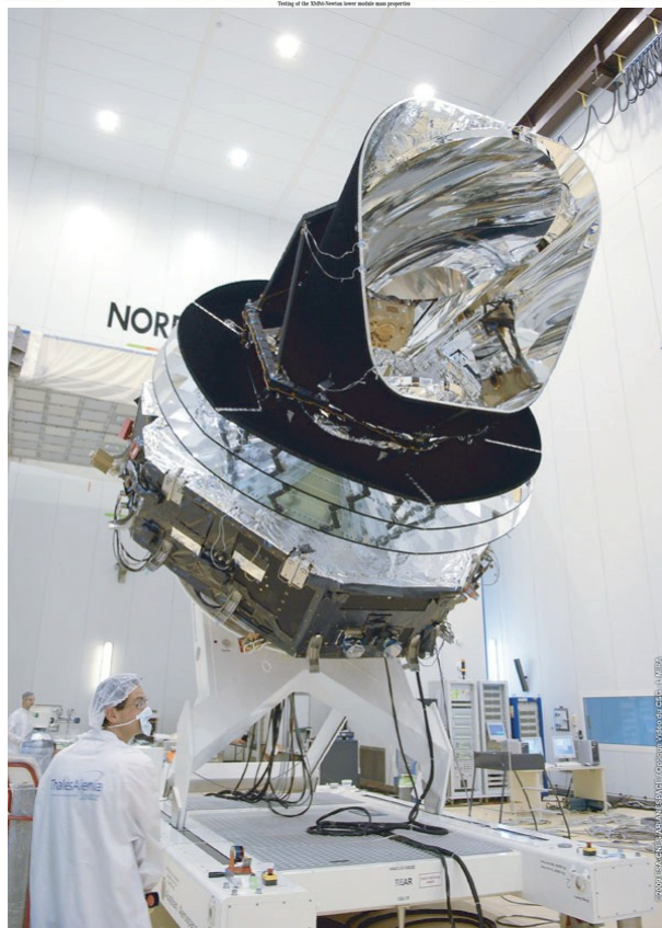
FIGURA 95 Arriba: el satélite XMM-Newton y sus espejos como cebolla (capas) de alta precisión que producen un mapa de rayos X del cielo nocturno. Abajo: el satélite Planck y sus antenas de microondas chapadas en oro que produjeron un mapa de alta resolución de la radiación cósmica de fondo (© ESA).
