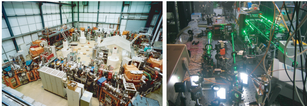
ABBILDUNG 11 Bewegte Uhren gehen langsamer: bewegte Lithiumatome in einem Speicherring (links) die mit Lasern ausgelesen werden (rechts) bestätigen die Vorhersage mit höchster Genauigkeit (© Max Planck Gesellschaft, TSR Relativity Team)
