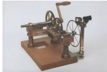
ABBILDUNG 4 Fizeau's Experiment zur Messung der Lichtgeschwindigkeit (Photo © AG Didaktik und Geschichte der Physik, Universität Oldenburg)
