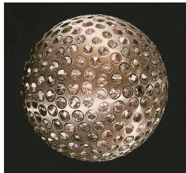
FIGURA 66 El satélite LAGEOS: esfera metálica con un diámetro de 60 cm, una masa de 407 kg, y cubierta con 426 retroreflectores (NASA).
