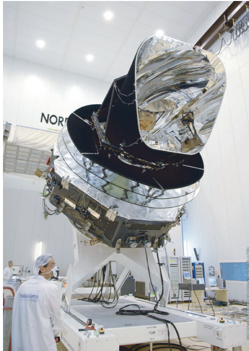
FIGURA 87 Arriba: el satélite XMM-Newton y sus espejos como cebolla (capas) de alta precisión que producen un mapa de rayos X del cielo nocturno. Abajo: el satélite Planck y sus antenas de microondas chapadas en oro que produjeron un mapa de alta resolución de la radiación cósmica de fondo (© ESA).
