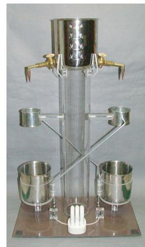
**FIGURA 6** Un sencillo generador Kelvin; El de la izquierda enciende una bombilla de luz fluorescente utilizando el goteo de agua (photograph © Harald Chmela).
