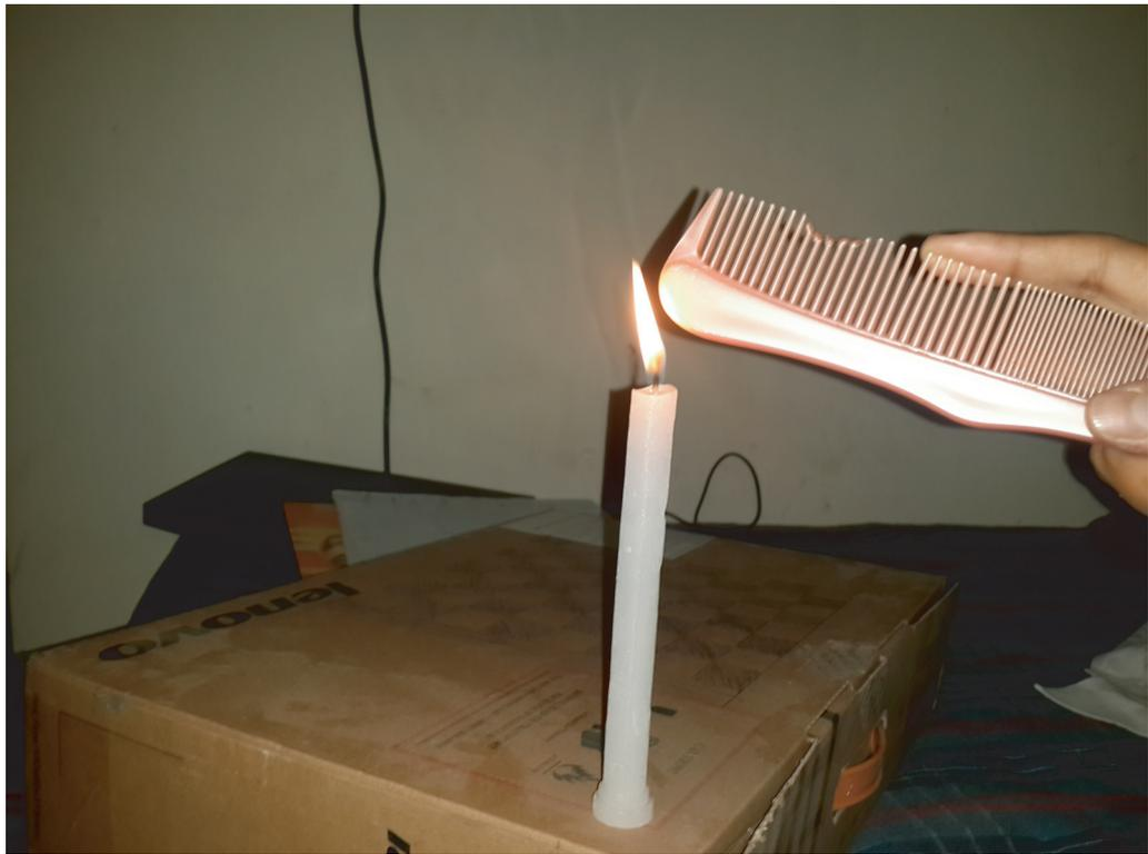
FIGURA 186 Forma en la que una llama reacciona con un peine frotado (© Shubham Das y Rakesh Kumar).
