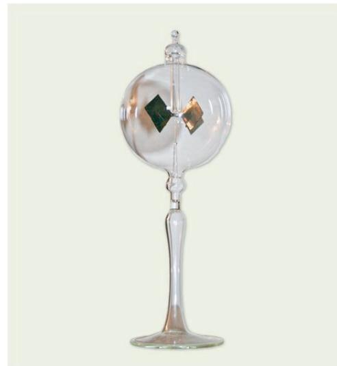
FIGURA 74 Un molino de luz comercial gira *en contra* de la luz (Wikimedia).
