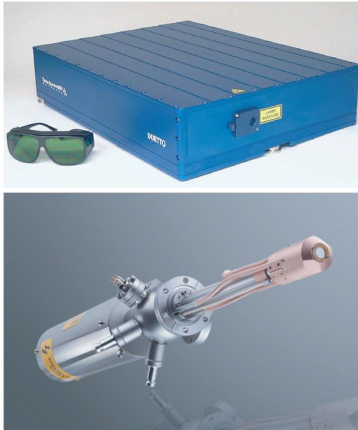
**FIGURA 97** Un moderno láser de un picosegundo de pulso y una fuente industrial de rayos-X, ambos de un tamaño de unos 700 mm (© Time-Bandwidth, SPECS).
