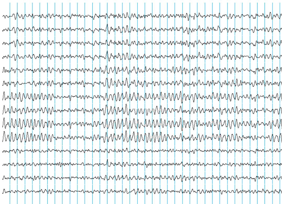
**FIGURA 175** Un electroencefalograma moderno, tomado en una serie de posiciones de la cabeza. Los voltajes medidos están alrededor de 0,1 mV (© Wikimedia).
