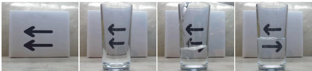
**FIGURA 103** Un bonito efecto de refracción en la interfaz agua-aire que puede repetir en casa (© Maric Vladimir).
