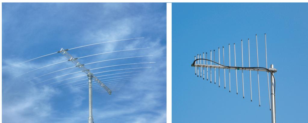
FIGURA 63 Antenas para ondas electromagnéticas polarizadas horizontal y verticalmente (© Martin Abegglen, K. Krallis).
