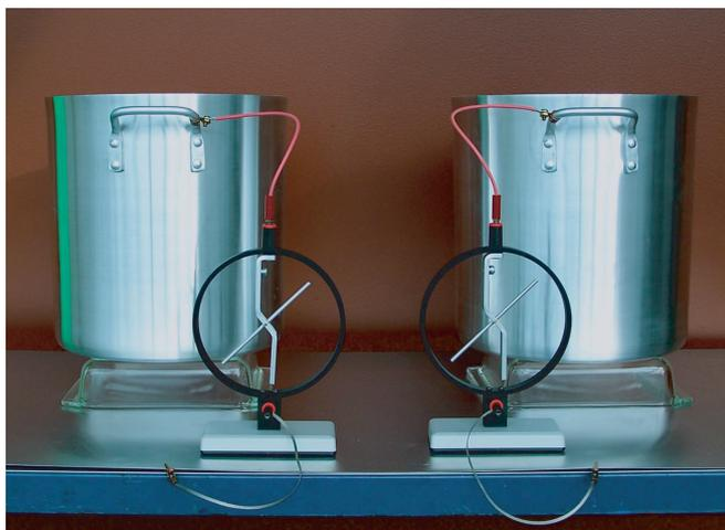
**FIGURA 8** Un equipo sencillo para confirmar la conservación de la carga eléctrica: si una piel frotada es movida desde el primer recipiente al segundo, la carga obtenida desde el primero es transferida al segundo recipiente, como muestran los dos electrómetros (© Wolfgang Rueckner).
