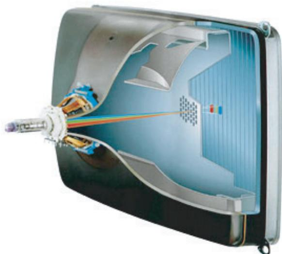
**FIGURA 148** Un tubo de rayos catódicos de las televisiones antiguas: la primera forma – ahora obsoleta – usaba señales eléctricas para producir los cambios de color en las imágenes. Los tubos de las televisiones emitían un rayo de electrones, lo desviaban y generaban luz por electroluminiscencia sobre una pantalla coloreada cubierta con un estampado de fósforo.
