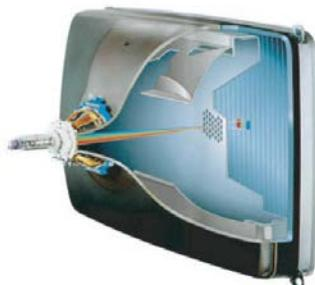
Slika 142 Katodna cev kod starijih TV aparata: prvi način – danas odbačen – da se proizvedu slike promenljivih boja korišćenjem elektronskog signala. TV cevi emituju elektronski zrak, skreću ga i proizvode svetlost elektroluminiscencijom na ekranu u boji prekrivenog uzorkovanim fosforom.
