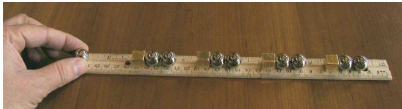
Slika 26 Gausova puška napravljena sa nekoliko čeličnih kuglica i četiri magneta pričvršćenih na lenjir pomoću lepljive trake (© Simon Quellen Field).
