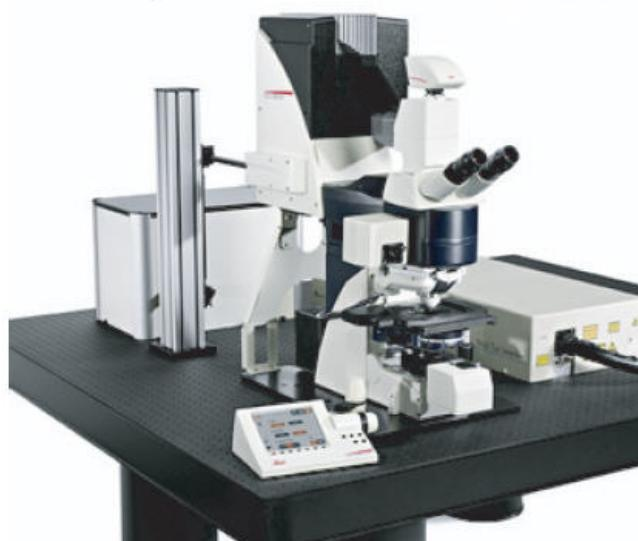
Slika 124 Dve tehnike skeniranja slika: mikroskop sa konfokalnim laserskim skeniranjem i multifotonski mikroskop (© Nikon, Carl Zeiss)
