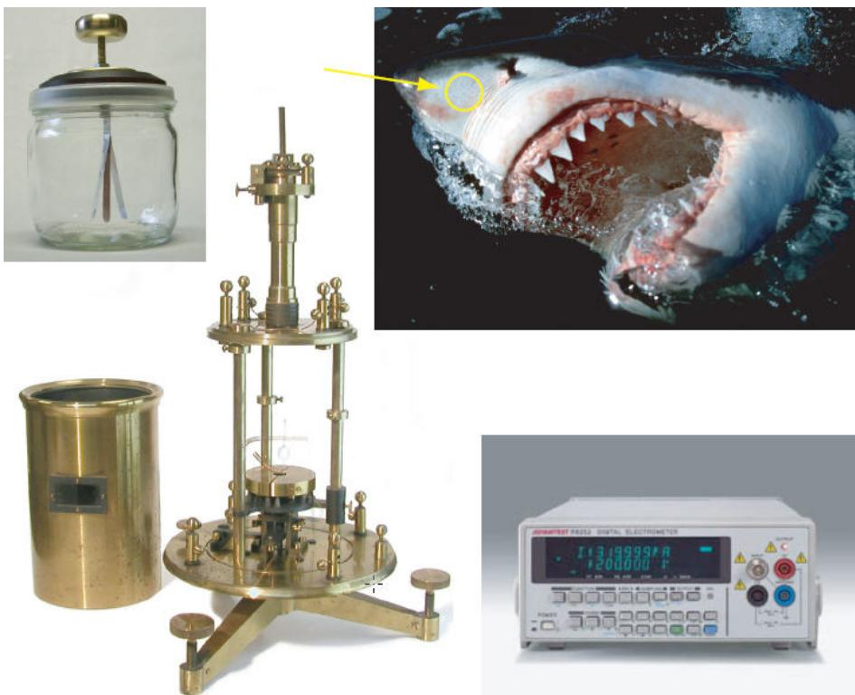
Slika 9 Razni elektrometri: elektrometar sopstvene izrade izrađen u tegli od marmelade, stari (otvoren) Dolezalek elektrometar velike preciznosti, Lorencinijeva ampula ajkule i savremen digitalni elektrometar (© Harald Chmela, Klaus Jost na web strani [www.jostimages.com/](http://www.jostimages.com/), Advantest).
