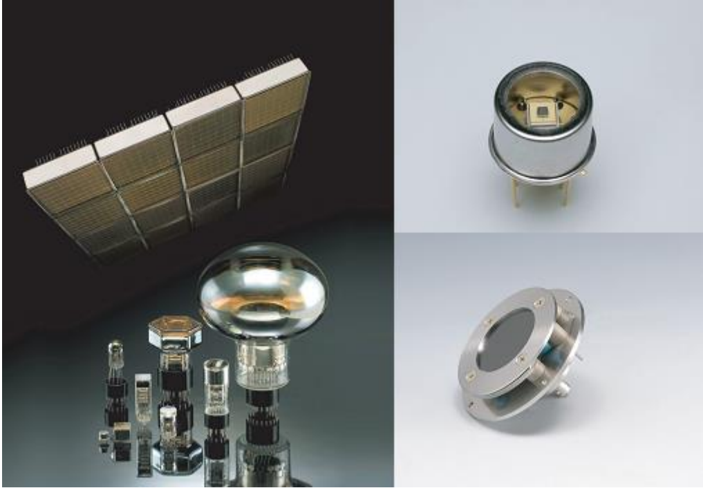
الشكل 17 – كواشف التي تسمح بعد الفوتونات : أنابيب مضاعفة ضوئية ( يسار ) ثنائي ضوئي انهيار ( يمين أعلى ) تقريبا 1cm ) ،صفحة متعددة القنوات ( يمين أسفل تقريبا 10cm )
