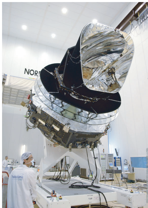
FIGURA 82 Alto: il satellite XMM-Newton e la sua alta precisione, specchi a cipolla che ha prodotto una mappa a raggi X del cielo notturno. In basso: il satellite Planck e le sue antenne a microonde placcate in oro che hanno prodotto una mappa ad alta risoluzione della radiazione cosmica di fondo (© ESA).
